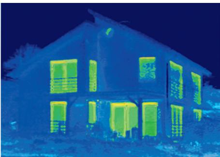
Dopo l'installazione di nuove finestre del sistema Schüco LivIng, la termografia dimostra l'elevato valore dell'investimento a livello energetico. Si evita quasi completamente la dispersione originale.
