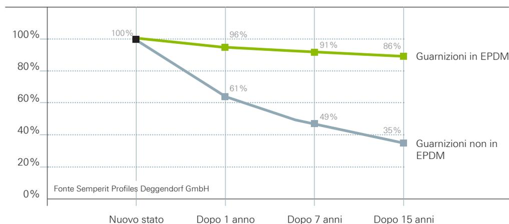
\*Comportamento di una guarnizione in caso di compressione ricorrente, ad esempio apertura e chiusura della finestra. Il risultato ottimale è il recupero della forma originale, perché solo questo garantisce una tenuta di lunga durata.
